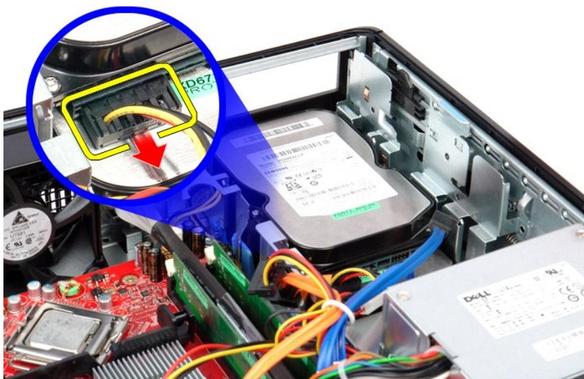
5. Tire del seguro de liberación de la unidad y deslice la unidad de disco flexible hacia la parte posterior del equipo.
