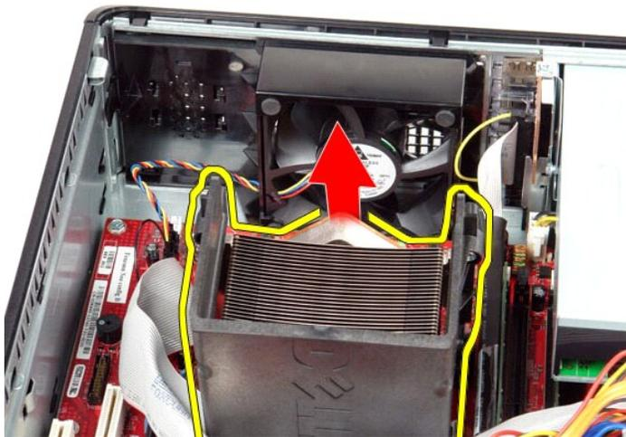
5. Deslice la palanca de liberación de debajo del pestillo de la cubierta central y gírela hacia arriba.
