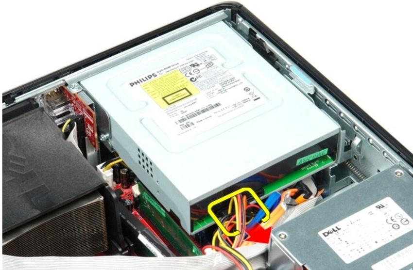
4. Levante el seguro de liberación de la unidad y deslice la unidad hacia la parte posterior del equipo.
