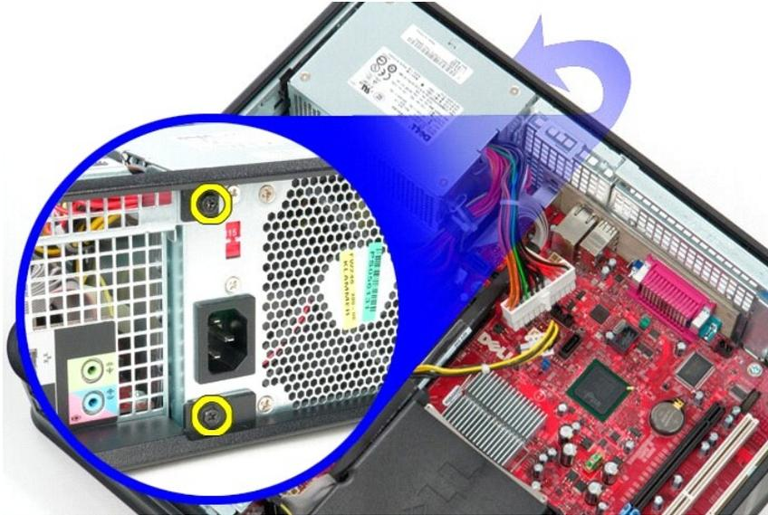
9. Presione el pestillo de liberación de la fuente de alimentación situado en la parte inferior del chasis y deslice la fuente hacia la parte frontal del equipo.
